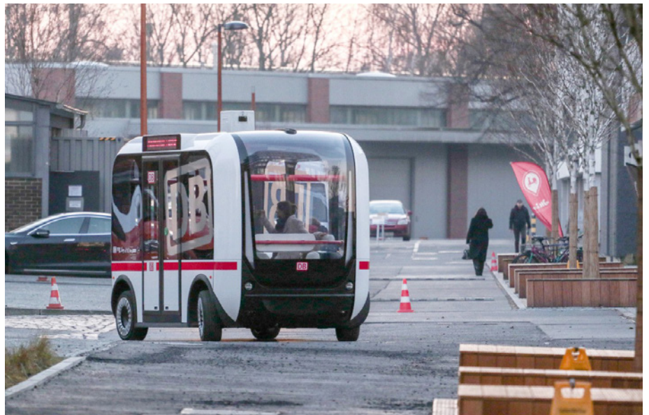
Bild 2: Das Shuttle folgt automatisch den in seinem Bordcomputer eingelesenen Routen, den sogenannten Trajektorien. Foto: Kai Michael Neuhold/DB
